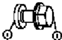
图1c. 新结构密封塞, 2522 731-A.
